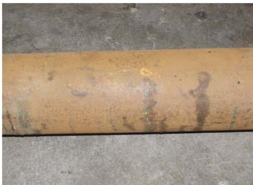
图 4-10 除锈前的钢管表面
