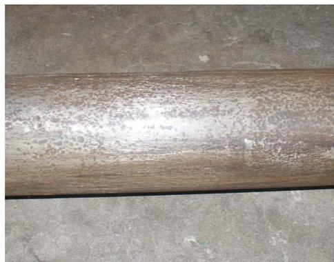
图 4-11 除锈处理后的钢管表面
