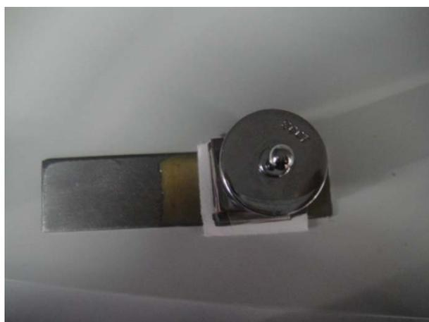
图 3-4 压滤纸法测定固化时间
