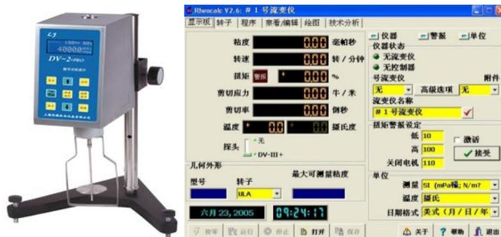
图 2-1 DV-III 数字粘度计及其软件操作界面
