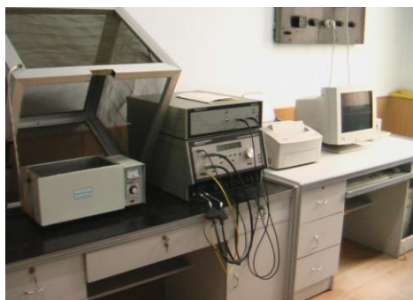
图 2-8 极化曲线测量装置
