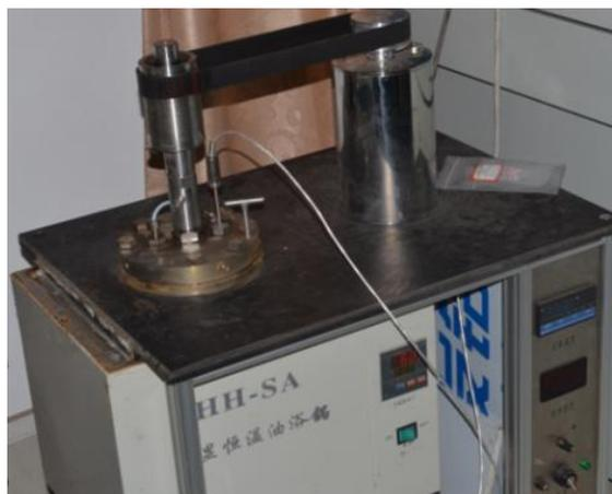
(b) 动态腐蚀仪
