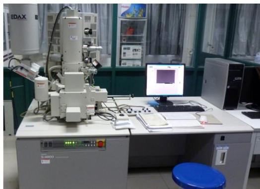
图 2-3 S-800 型冷场发射扫描电子显微镜
