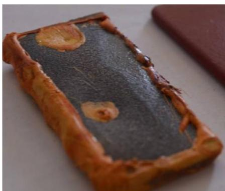
图4-14 Ta涂层侧面腐蚀形貌
