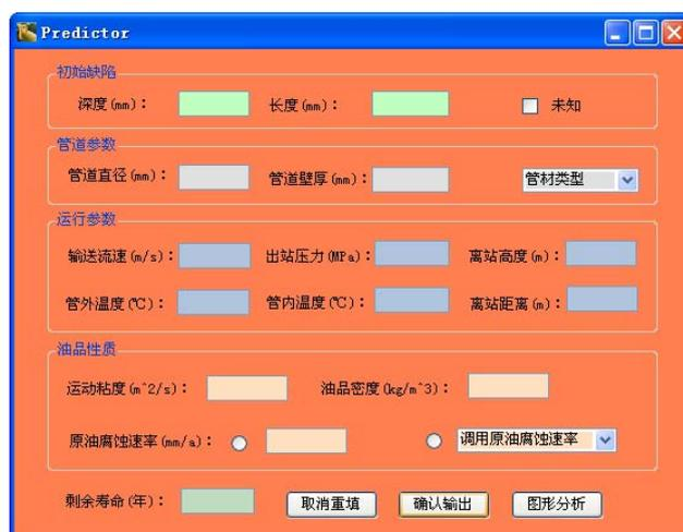
图 4-7 管线内腐蚀剩余寿命预测模块
